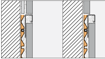
Einbauvariante: Wand-Begrenzungsprofil Schlüter®-QUADEC
