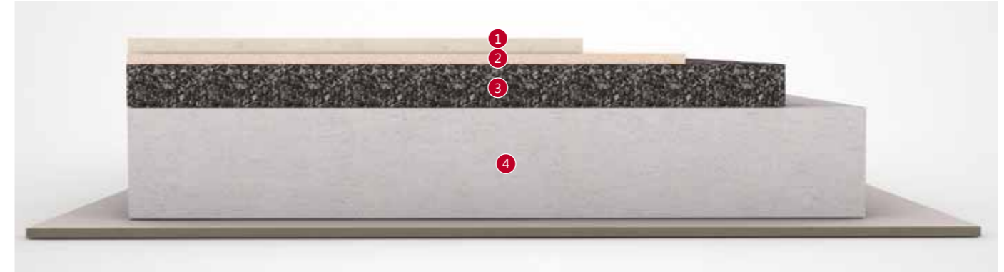
Trockenestrich auf unebener Bodenplatte (vollflächige Verarbeitung der Schüttung)
