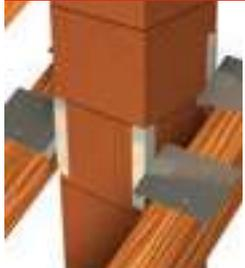
Nicht zusätzlich armierte Abgasanlagen sind generell im Dachdurchtritt seitlich abzustützen, um die Windkräfte sicher ableiten zu können. Dies kann einfach, schnell und sicher mit dem optionalen Erlus Sparrenhalter-set SP4 erfolgen.
