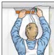
**4.** Überstände an Decken, Fußleisten, Fenster (gem. Online-Hilfe) usw. mit dem Cuttermesser und dem Tapezierspachtel abtrennen.
