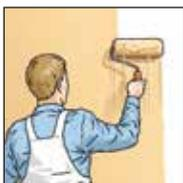
**6.** Die ERFURT Vliesfaser Ready ist vorgestrichen. Nach dem Tapezieren ist kein Anstrich erforderlich. Die Fertig-Tapete kann im Bedarfsfall mit einer geeigneten Farbe, idealerweise einer Dispersionsfarbe (mind. Nassabriebsklasse 3 nach DIN EN13300), beschichtet werden.
