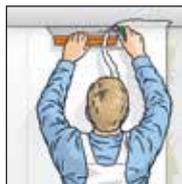
**4.** Überstände an Decken, Fußleisten, Fenstern usw. mit dem Cuttermesser und dem Tapezierspachtel abtrennen.
