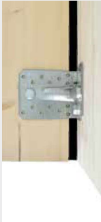
Gemessener Aufbau – mit Winkelverbinder und Schrauben
